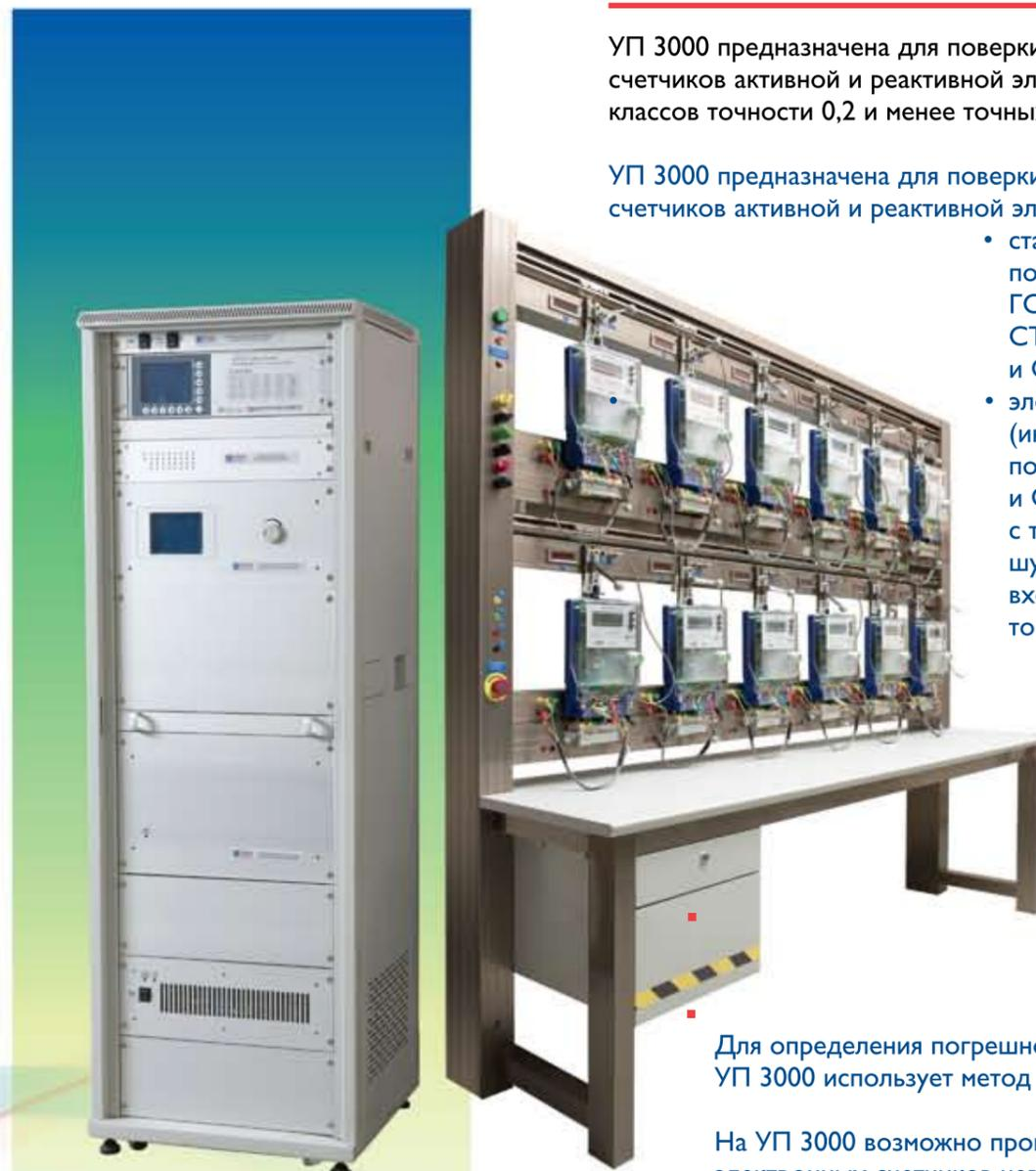
Для определения погрешности тестируемых счетчиков УП 3000 использует метод эталонного счетчика.
