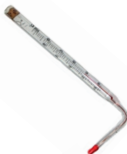
Термометр технический жидкостный угловой
