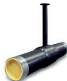
Кран стальной шаровый цельносварной полнопроходной LD с удлинённым штоком
