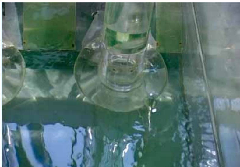
Рис. 5.1: Вихрь в макете насоса, засасывающий воздух
