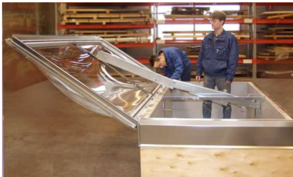
Подготовка к испытаниям люка на надежность на заводе Oriville фирмы Keraplast в 2005 году
