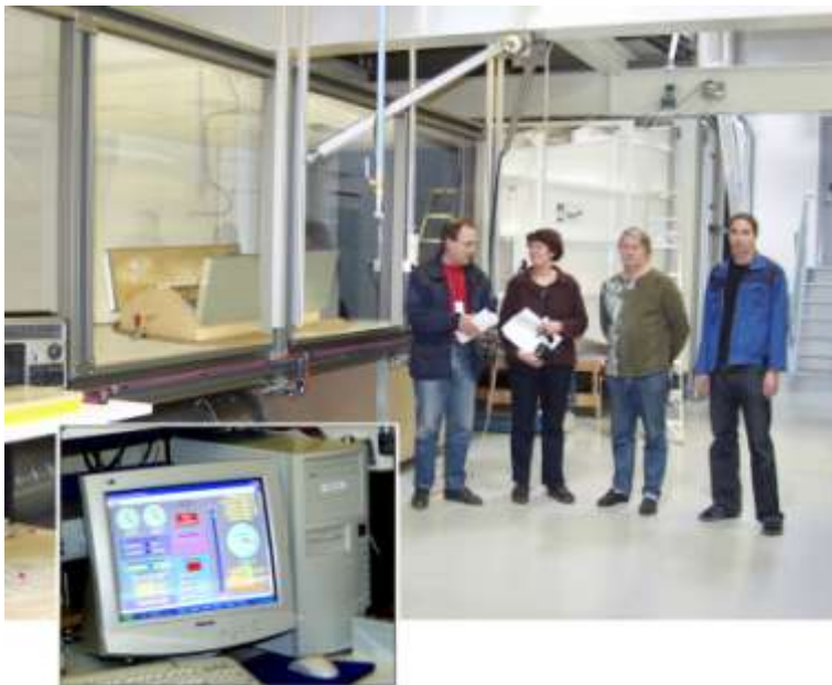
Испытания люка дымоудаления типа Ori 51/HT на ветровую нагрузку в 2004 году в лаборатории ТКК*
