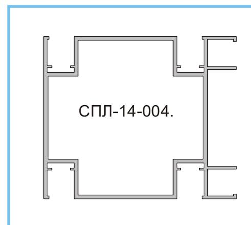
При помощи профиля стоечного 3-х стороннего **СПЛ-14-004** можно выполнить соединение 2-х перегородок под углом 90 градусов (Т-образное соединение), а также примыкание двух перегородок под прямым углом. При этом перегородки могут иметь различное заполнение.
