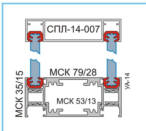
В качестве торцовочного профиля возможно использовать СПЛ-14-007. Кроме того, этот профиль позволяет оформить открытые проёмы (проходы) в перегородках, после чего в них можно монтировать раздвижные двери-гармошки и обычные распашные глухие и стеклянные двери используя стандартные крепёжные элементы.
