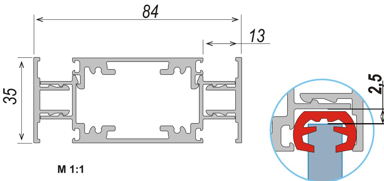
Зазор между стеклом и профилем составляет 2,5 мм на сторону.
