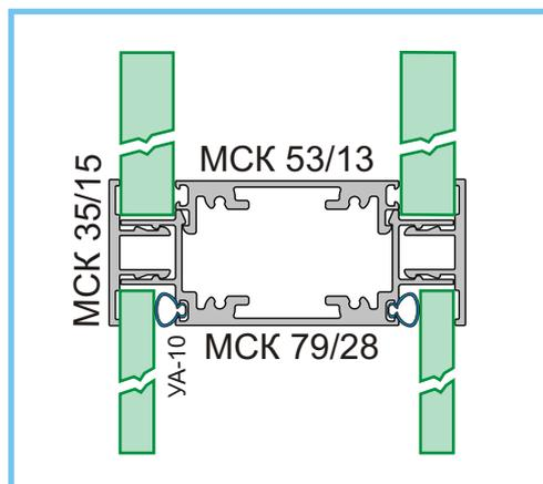
**Глухие** секции заполняются любым плитным материалом толщиной до 13-ти мм: гипсокартонными панелями, окрашенными или с виниловым покрытием ; ламинированным ДСП, МДФ, различными видами пластика. Внутреннее пространство между плитами заполняется минеральной ватой, создавая дополнительную звукоизоляцию. Для фиксации заполнения толщиной 6-8 мм используются пластиковые уплотнители **УА-10**.
