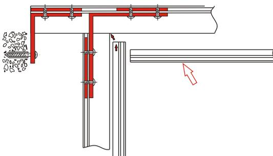
После сборки каркаса перегородки устанавливаются защёлки МСК 53/138.
