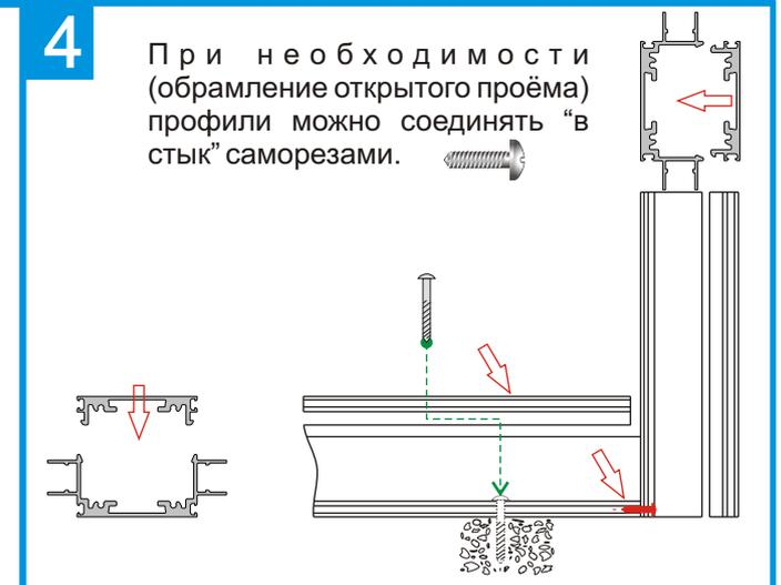
В целях удобства крепления к стенам (полу, потолку) профили стоек(ригелей) могут иметь различную длину .
