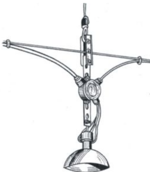
Рисунок 4.11.5 Узел ответвления к светильнику
