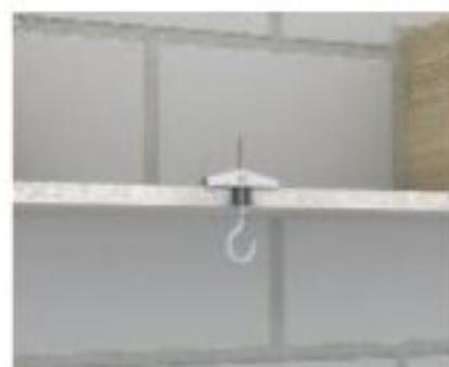
Пружинно-откидной и откидной дюбель Вследствие распрямления боковых лапок создается поверхность прилегания на пластине. Путем поворота резьбы крючок приводится в правильное положение и фиксируется гайкой.
