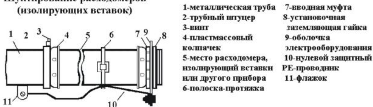
Рисунок 7.9 - Шунтирование расходомеров, задвижек.
