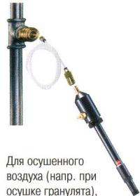
Для осущеного воздуха (напр. при осушке гранулята), необходим тefлоновый шланг и камера для измерений, клапан камеры полностью открыт
