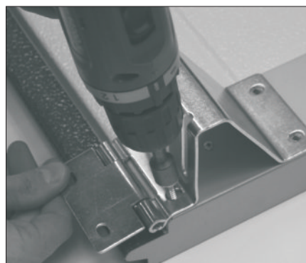
20. Боковые петли с кронштейном для роликов.
