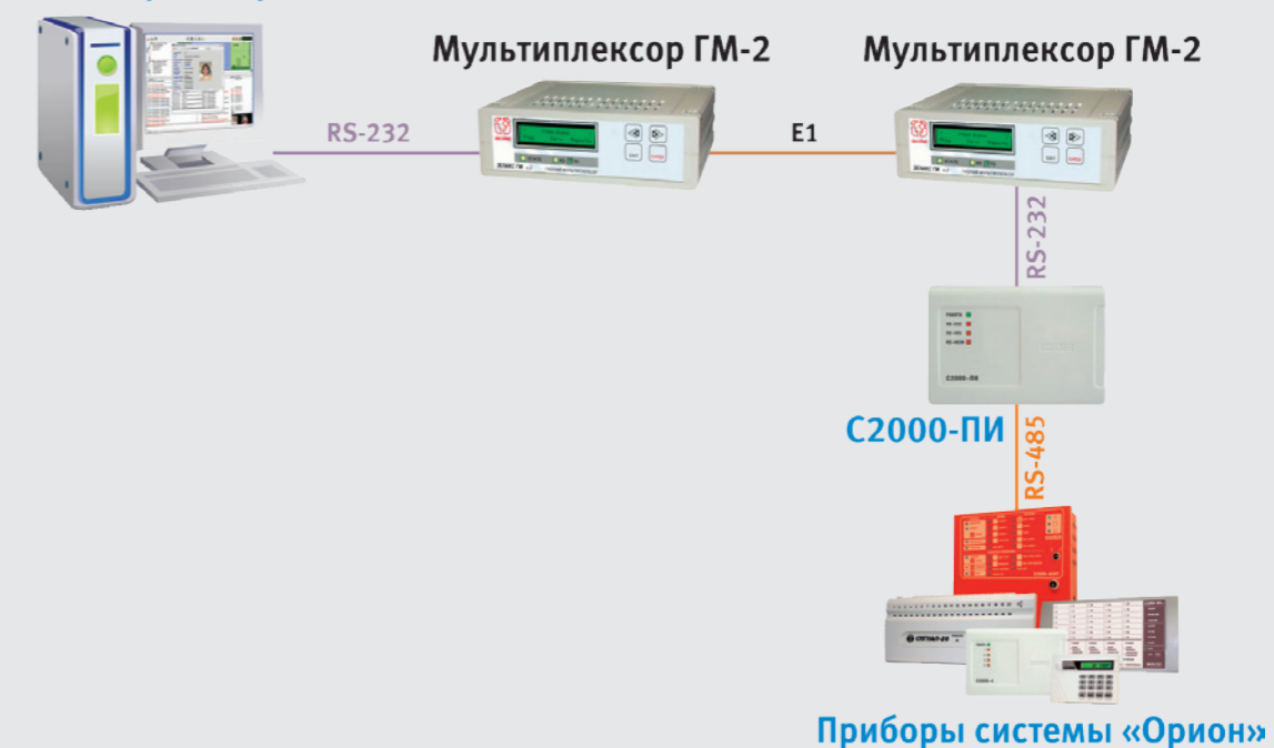
Рисунок 66. Структурная схема использования мультиплексора «ГМ-2» с АРМ «Орион»/«Орион Про»
