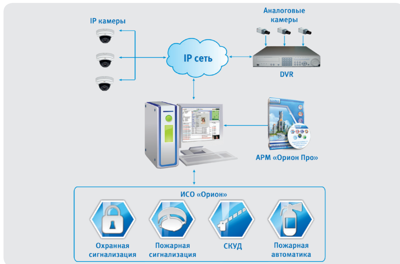
Рисунок 46. IP-видеонаблюдение в ИСО «Орион» с АРМ «Орион Про»
