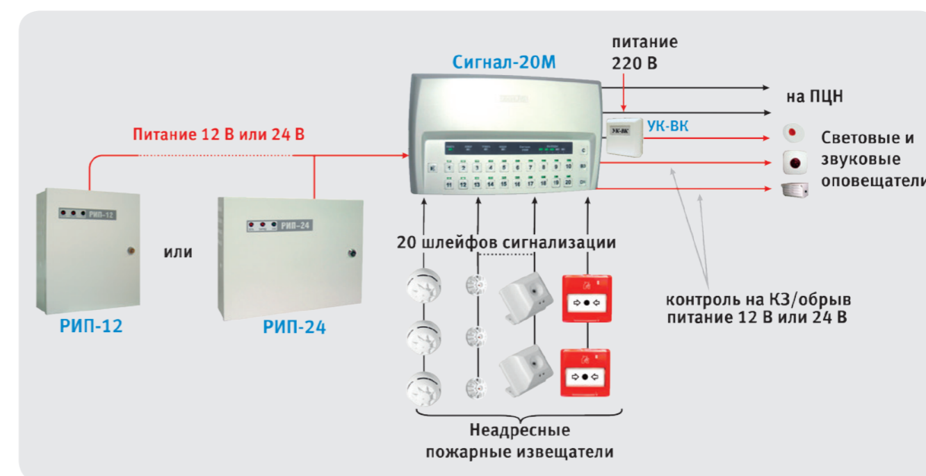
Рисунок 5. Использование прибора «Сигнал-20М» в автономном режиме
