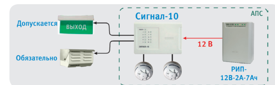
Рисунок 12. Пример СОУЭ 1-го типа на базе прибора «Сигнал-10»
