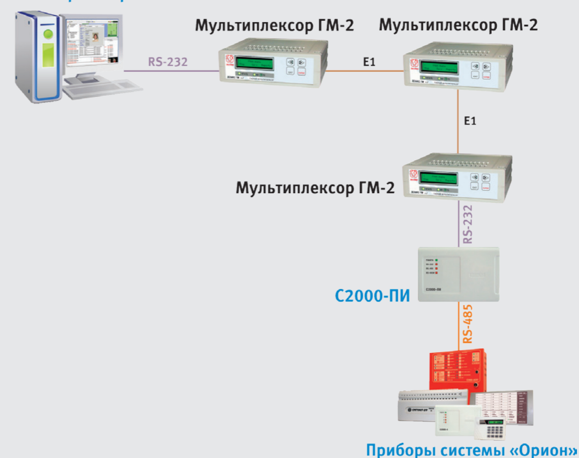
Рисунок 67. Структурная схема использования мультиплексора «ГМ-2» с АРМ «Орион»/«Орион Про» с подключением промежуточного мультиплексора (ремultipлексирование)
