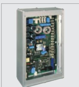
Компактный блок управления с частотным преобразователем и векторным контролем, способствующему тихому и плавному ходу ворот.
