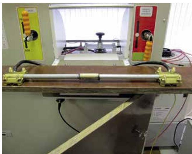
Испытание элементов УЗК импульсным током
