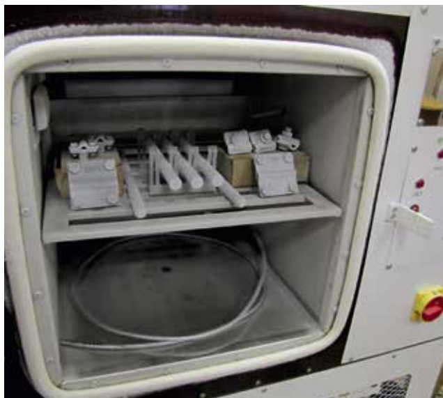
Испытание элементов УЗК на климатическое воздействие
