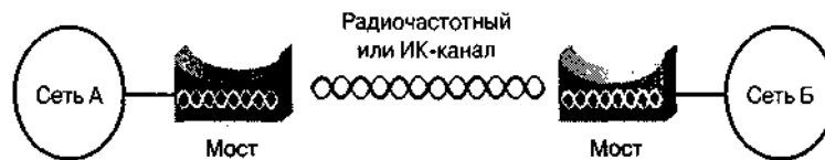
Рис. 6.1. Мосты служат для соединения двух сетей
