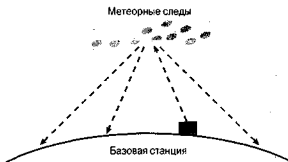
Рис. 7.8. Системы метеорной связи используют метеорные следы для отражения сигналов обратно к Земле
