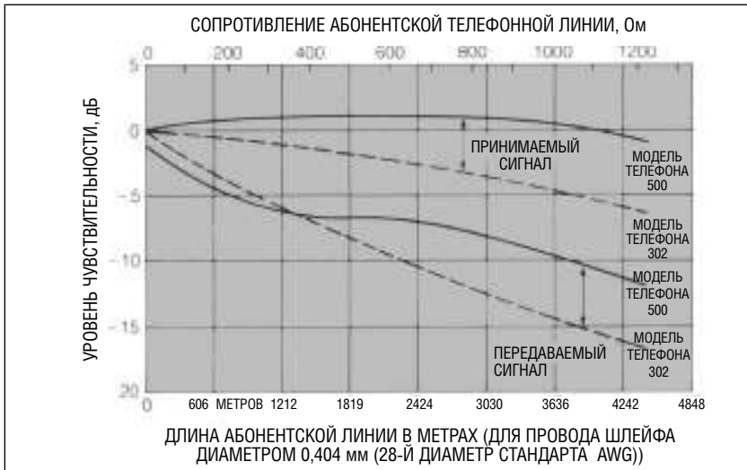
Рис. 3.18. Стандартный телефонный аппарат. Относительные уровни громкости звuka в зависимости от длины абонентской телефонной линии (с любезного разрешения Лаборатории Bell)
