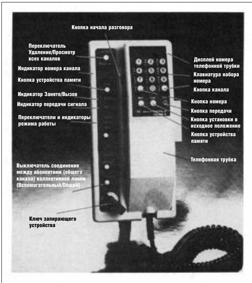
Рис. 11.3. Внешний вид блока управления мобильного телефонного аппарата (с любезного разрешения компании Motorola Inc.)
