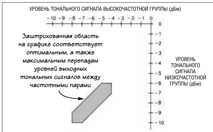
Рис. 2.6. Технические условия на уровень передаваемых двухтональных многочастотных сигналов
