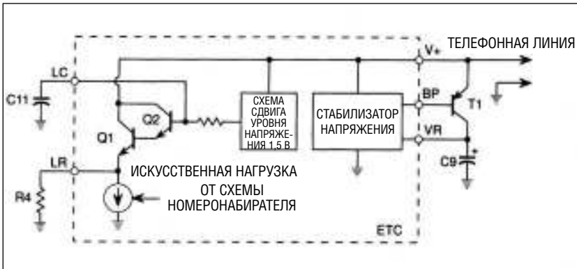
Рис. 5.2. Принципиальная блок-схема линейного интерфейса (с любезного разрешения компании Motorola Inc.)
