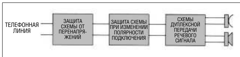
Рис. 3.3. Блок-схема цепей тракта речевого сигнала телефонного аппарата
