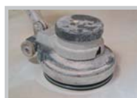
Шлифование, для мягкого основания или чтобы выровнять шероховатое основание
