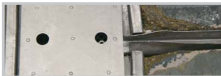
Следствие проникновения воды: отслоения на сливах, которые могут представлять большую опасность для гигиены
