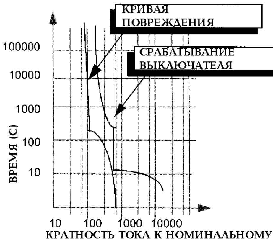
ДИАГРАММА СРАБАТЫВАНИЯ АВТОМАТИЧЕСКОГО ВЫКЛЮЧАТЕЛЯ В ЛИТОМ КОРПУСЕ И КРИВАЯ ПОВРЕЖДЕНИЯ ГЕНЕРАТОРА
