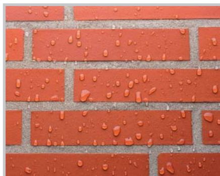
Высокая степень водоотталкивания – эффект «жемчуга»
