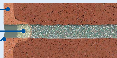
Дополнительная пропитка продуктом Remmers Funcosil SNL
