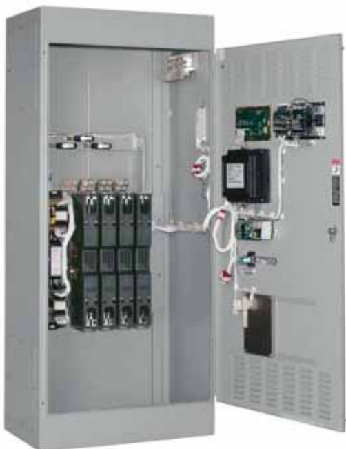
Рис. 2: Четырехконтактное устройство автоматического включения резерва без разрыва цепи на 1000 ампер в корпусе типа 1.
