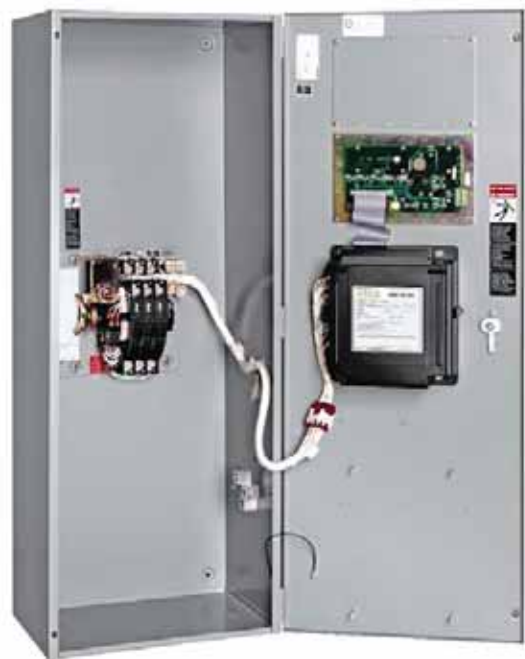
Рис. 4: Трехконтактное неавтоматическое устройство включения резерва с электрическим управлением, рассчитанное на 200 ампер в корпусе типа 1.
