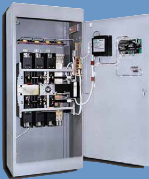
Рис. 1: Трехполюсное устройство автоматического включения резерва 7000 Серии, рассчитанное на 1600 ампер (показано с дополнительными подключенными спереди разъемами и менеджером питания).
