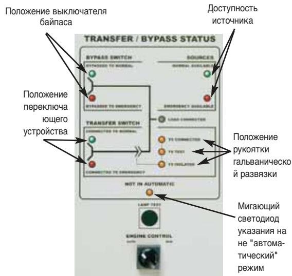
Рис. 10: Панель состояния байпаса
