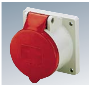
⚠ IP44, панельные розетки CEE, безвинтовые клеммы, TwinCONTACT, фланец: 75 X 75 мм, прямой угол Размеры: см. стр. 70/71
