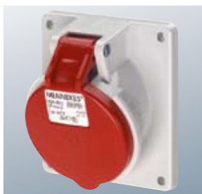
⚠ IP44, панельные розетки CEE, безвинтовые клеммы, TwinCONTACT, фланец 16A, 3 пол.: 73,5 X 64 мм, 16A, 4+5 пол., 32 A: 100 X 92 мм, угол наклона 20° Размеры: см. стр. 70/71
