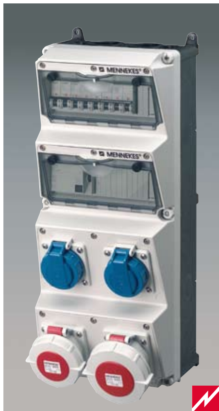
АМАХХ® специальное оборудование для верфей и контейнерных терминалов. Розетки с механической блокировкой DUO в стандартной комплектации для рефрижераторных контейнеров 32А, 4п, 3л, 440В. Так же возможна поставка с контрольными розетками. См. стр. 61.
