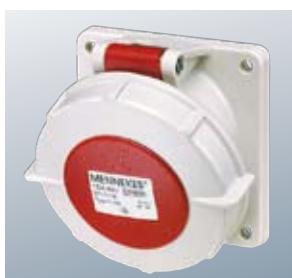
⚠ IP67, панельные розетки CEE, безвинтовые клеммы, TwinCONTACT, стандартный размер фланца 85 X 85 мм, угол наклона 20° Размеры: см. стр. 71
