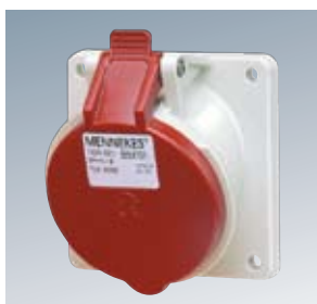
⚠ IP44, панельные розетки CEE, безвинтовые клеммы, TwinCONTACT, стандартный фланец 85 X 85 мм, угол наклона 20° Размеры: см. стр. 70/71
