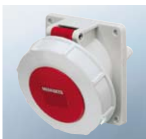
⚠ IP67, панельные розетки CEE, безвинтовые клеммы, TwinCONTACT, фланец 16A, 3пол.: 73,5 X 64 мм, 16A, 4+5 пол., 32A: 100 X 92 мм, угол наклона 20° Размеры: см. стр. 71
