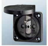
Панельные розетки с заземляющим контактом французского/ бельгийского стандарта, с шарнирной крышкой, со шторками, 3 безвинтовых клеммы для проводов сечением 1,5-2,5 мм²
