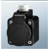
Панельные розетки SCHUKO® немецкого стандарта, с шарнирной крышкой, 3 безвинтовых клеммы для проводов сечением 1,5-2,5 мм², ввод кабеля М 20 х 1,5 сверху с кабельным вводом и М 20 х 1,5 слепой (прорезать отверстие) снизу, с помощью выступа и паза могут монтироваться друг на друга в колонну
