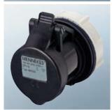
Панельные розетки серии RAPIDO® технология TwinCONTACT, безвинтовые пружинные клеммы, с возможностью проходного соединения, для монтажного отверстия диаметром 61 мм, центральная крепежная система без крепежных фланцев.
