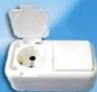
Блок В-РЦ-207 брызгозащищенный для открытой установки. Состоит из однополюсного выключателя и розетки с заземляющими контактами. Размеры: 134x73x54 мм.
