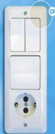
Блок 3В-PC-651. Состоит из выключе- телей (двухклавишного и одноклавишного) и розетки с заземляю- щими контактами. Размеры блока: 210x80x52, коробки: 175x70x30 мм.
