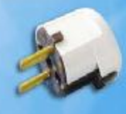
Вилка штепсельная B16-242 с заземляющим контактом с боковым подводом провода. Номинальный ток — 16 А. Напряжение — 250 В. Размеры: 41,2x36,5x55,5 мм.
