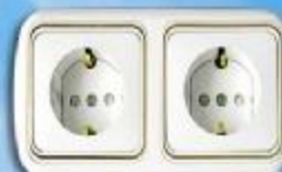
Розетка двухместная PC16-284 с заземляющими контактами и шторками. Размеры: 151x80x45.
