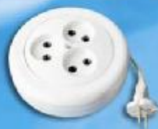
Удлинитель трехместный Y6-240 . Суммарная мощность потребителей – не более 1500 Вт. Номинальный ток – 6 А. Длина шнура – 5,2 м. Размеры: диаметр – 145, h – 47 мм.
