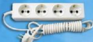
Удлинитель четырехместный Y10-210 с заземляющими контактами. Суммарная мощность потребителей – не более 2500 Вт. Номинальный ток – 10 А. Длина шнура – 3,5 м.
