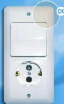
Блок В-PC-647. Состоит из одноклавишного выключателя и розетки с заземляющими контактами. Размеры блока: 158x80x52, коробки: 123x70x30 мм.
