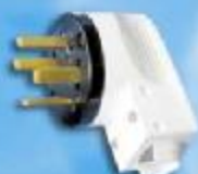
Вилка 3-х фазная B32-003 с заземляющим контактом. Номинальный ток — 32 А. Напряжение — 440 В. Размеры: 102x67x88 мм.
