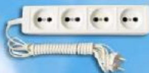
Удлинитель четырехместный Y6-219 . Суммарная мощность потребителей – не более 1500 Вт. Номинальный ток – 6 А. Длина шнура – 3,5 м.
