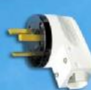
Вилка к электроплите B32-001 с заземляющим контактом. Номинальный ток — 32 А. Напряжение — 250 В. Размеры: 102x67x88 мм.
