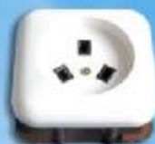
Розетка к электроплите PC32-006 с заземляющим контактом для скрытой установки. Номинальный ток — 32 А. Напряжение — 250 В. Размеры: 100x100x52 мм.
