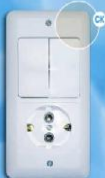
Блок 2В-PC-649. Состоит из двухклавишного выключателя и розетки с заземляющими контактами. Размеры блока: 158x80x52, коробки: 123x70x30 мм.
