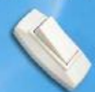
Выключатель клавишный BSH-212,5-001 устанавливаемый на шину. ТУ 208.03968179.57-92. Номинальный ток — 2,5 А. Размеры: 63x35x27 мм.
