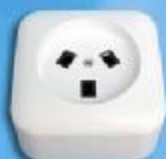
Розетка к электроплите PA32-002 с заземляющим контактом для открытой установки. Номинальный ток — 32 А. Напряжение — 250 В. Размеры: 100x100x52 мм.
