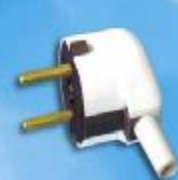
Вилка штепсельная B6-241 с боковым подводом провода. Номинальный ток — 6 А. Напряжение — 250 В. Размеры: 60,5x36,5x50 мм.
