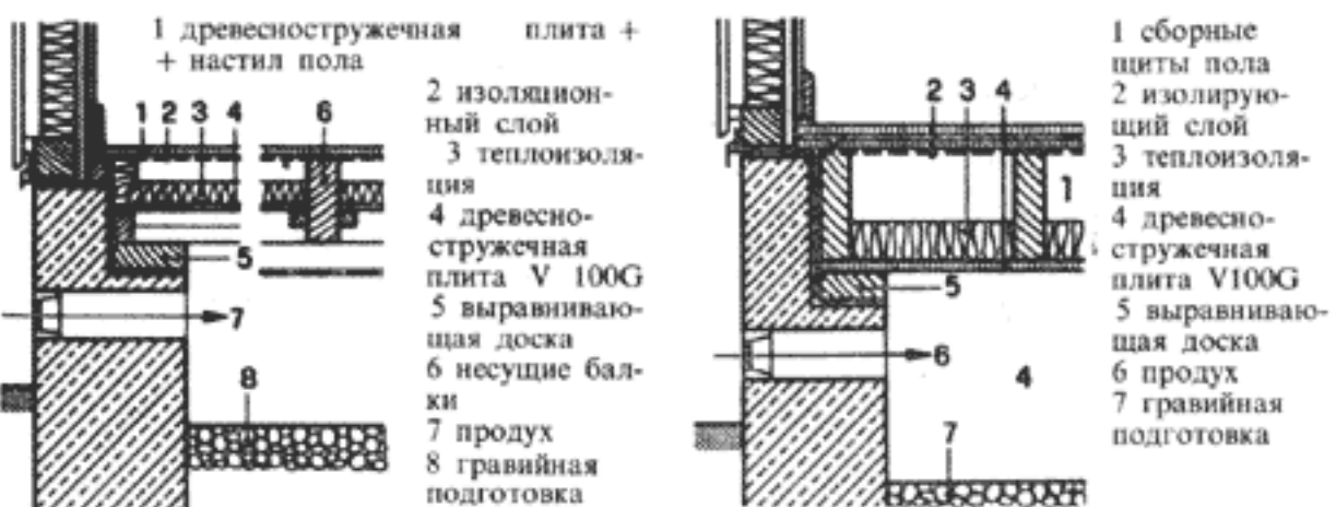
76 Бетонируемые на месте ленточные фундаменты с деревянной несущей конструкцией пола. На бетонный ленточный фундамент, выполненный на месте, укладывают деревянные балки. Между балками на привинченные к ним с обеих сторон черепные бруски кладут плиты. Эти плиты могут быть покрыты слоем теплоизоляции. При исполнении конструкции пола в соответствии с рис. 76–78 надо особенно придерживаться указаний, изложенных в DIN 68800, с.2
