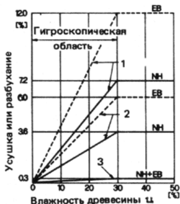
25 Кривые разбухания европейской хвойной древесины (NH) и дуба и бука (EB); 1 — тангенциальное, радиальное и продольное направления
