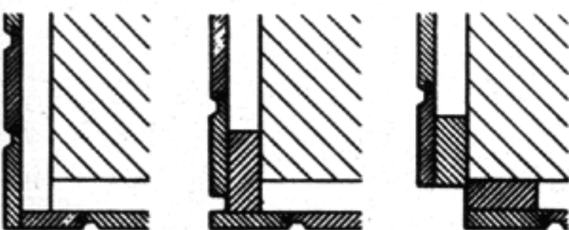
55 Угловое примыкание при вертикальной обшивке досками
