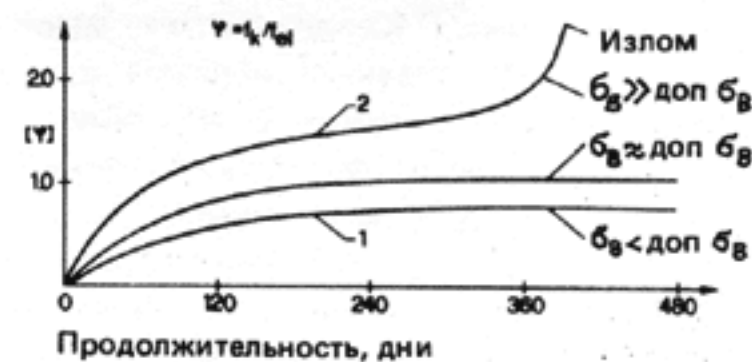
41 Кривые ползучести балок, работающих на изгиб
