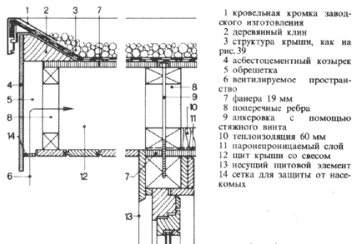
40-41 Кровельные щиты со свесом
