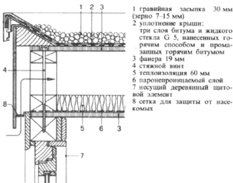
38-39 Кровельные щиты соединены со стенами заподлицо
