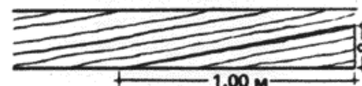
5 Диагональные волокна; допустимое отклонение волокон a на 1 м длины: класс I a = 70 мм класс II a = 120 мм
