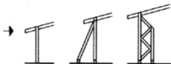
Зашемленные подпорки и стойки
