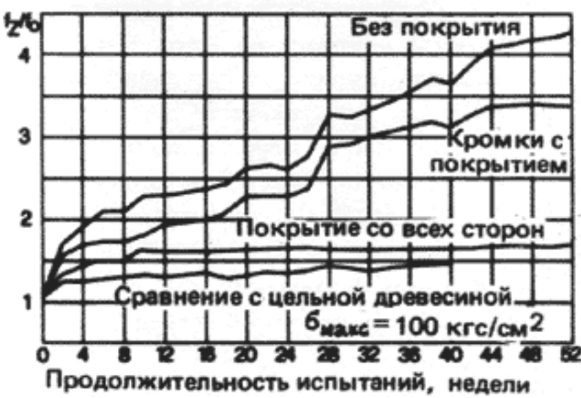
50 График относительных прогибов f_z/f_0 древесностружечных плит толщиной 25 мм, склеенных фенольной смолой, при семидневных циклах напряжений от \sigma_c до \sigma_c/2
