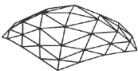
1/4 сферы с четырехугольной сеткой и диагоналями
