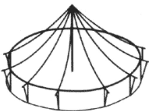
Радиальная растянутая система со сжатым кольцом
