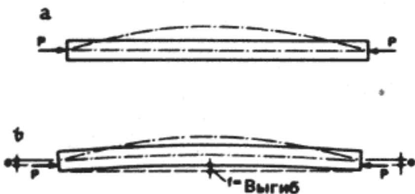
36 Продольный изгиб при центральном (а) и внецентренном (б) сжатии
