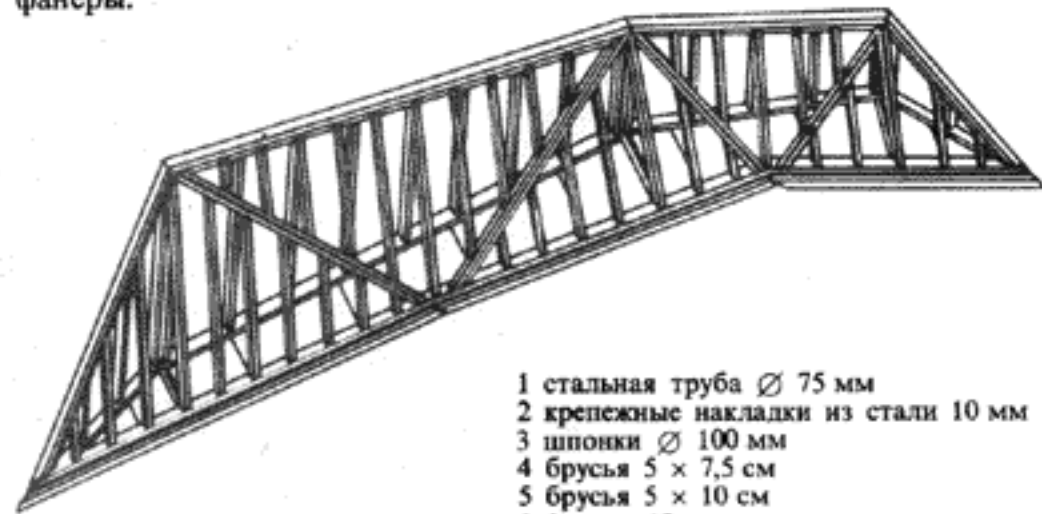
План складчатой конструкции
