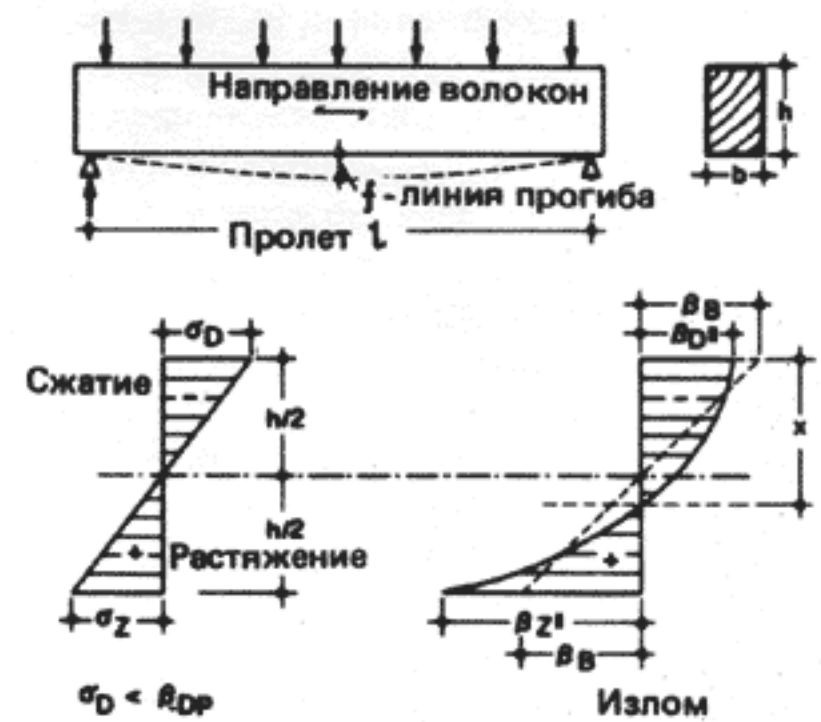
38 Изгиб балки сплошного сечения
