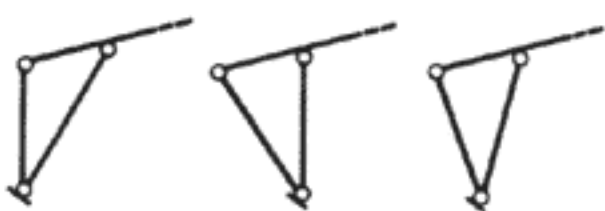
V-образные стойки рамы
