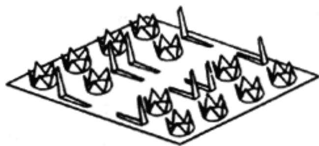
19а Гвоздевая плита системы «Туинауплэйт». Когти у круглых отверстий используются для передачи усилий, гвозди у продолговатых отверстий — для анкерки гвоздевой плиты
