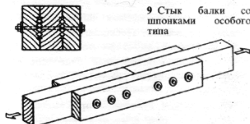
8: а — двухсторонняя шпонка (система «Гека»); б — двухсторонняя кольцевая шпонка (система «Апель»); в — односторонняя зубчатая шпонка (система «Бульдог»). Шпонки особой конструкции обозначают следующим образом: название системы, диаметр в мм, диаметр болтов в мм. Пример: одностороннее соединение (система «Гека»), наружный диаметр 65, болты М 16
