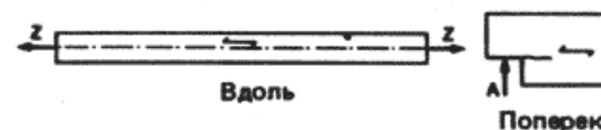
37 Напряжение растяжения вдоль и поперек волокон
