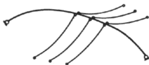
Висячие вспомогательные балки на продольных арках
