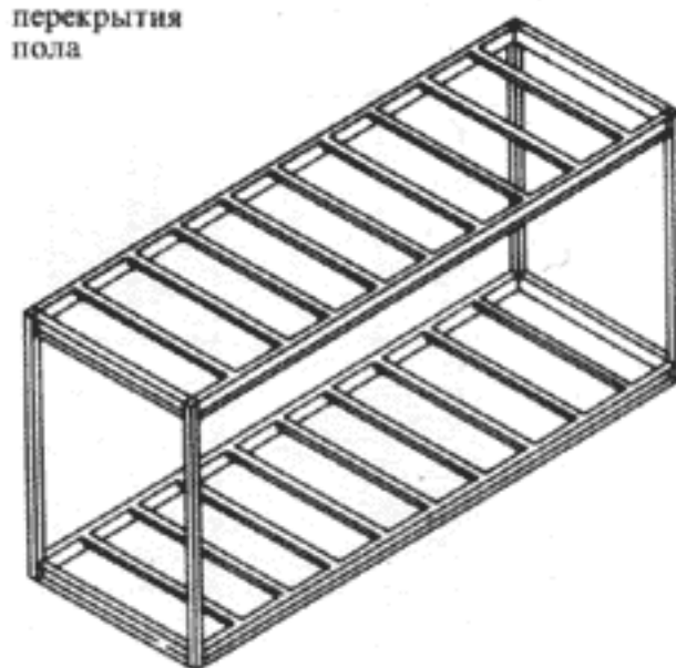
121 Стальная несущая система объемной ячейки. Все ограждающие элементы—полы, стена, крыша, фасад—из дерева или древесных материалов
