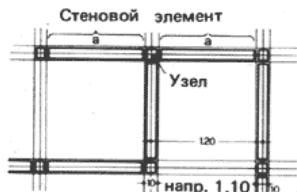
45b Ленточная сетка (все элементы одной ширины)
