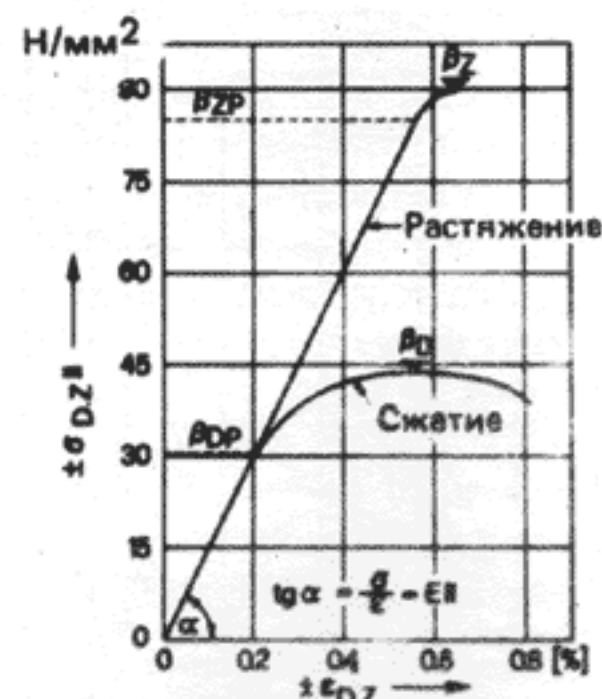
29 Диаграмма \sigma — \epsilon для хвойной древесины при растяжении и сжатии вдоль волокон
