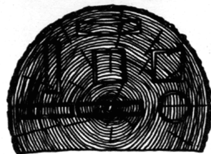
27 Изменения формы пиломатериала в результате усушки
