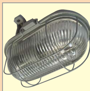
НПП 03-100-006 "Круг" ☛ : 1 x 100 Вт Стекло: силикатное прозрачное стекло Корпус: модифицированный полипропилен с решеткой из этого же материала ☛ : 8 шт. Ø / h: 220/100 мм Группа по прайс-листу Э 21.
