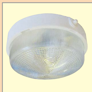
Тип: НБО 21-100-002 "Раунд 1" ☛ : 1/ до 100 Вт Стекло: силикатное прозрачное Корпус: полипропилен ☛ : 8 шт. Ø / h - 230 / 100 мм
