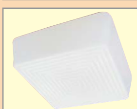
НПБ 01-2x60-134 ("Maxel") Марка плафона: 11-417 опал/мат "Арена" ☛ : 2 x 60 Вт Стекло: молочно-накладное / матированное ☞ : 5 шт. / инд. упаковка. Размеры светильника: 245x245x130мм
