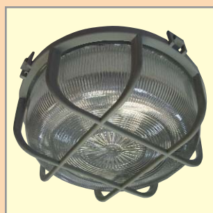
НПП 03-100-006 "Круг" ☛ : 1 x 100 Вт Стекло: силикатное прозрачное стекло Корпус: модифицированный полипропилен с решеткой из этого же материала ☛ : 8 шт. Ø / h: 220/100 мм Группа по прайс-листу Э 21.
