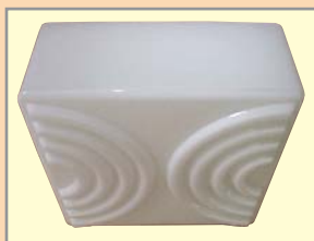
НПБ 01-60-124 ("Maxel") Марка плафона: 01-407 опал/мат "Дуга" ☛ : 1 x 60 Вт Стекло: молочно-накладное / матированное ☞ : 5 шт. / инд. упаковка. Размеры светильника: 245x245x130мм
