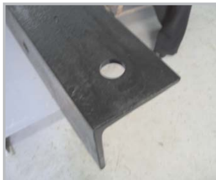
Обработанное отверстие \varnothing 25\text{мм}
