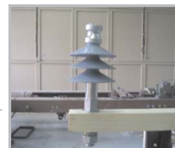
Вид установленного изолятора на деревянной траверсе
