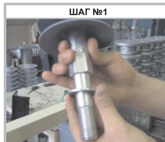
Установите верхнюю плоскую шайбу на изолятор
