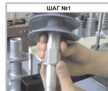
Установите верхнюю плоскую шайбу на изолятор
