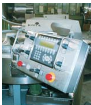
Пример 16 Премиум панель с боковым креплением несущего рычага CP-S. Специально предназначена для использования в пищевой промышленности
