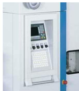
Пример 4 Широкая рама VIP, встроенная в машинный корпус
