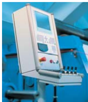
Пример 9 Командная панель с клеммной коробкой KL в качестве корпуса клавиатуры
