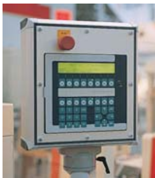
Пример 7 Отипанель с управлением и аварийным выключателем, встроенными в адаптерную панель
