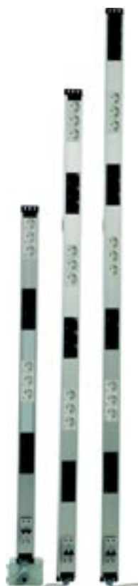
M44 xx nn ALD - вертикальный блок розеток (nn-высота в U - 36 или 42, xx-кол.розеток - 9, 12, 18)
