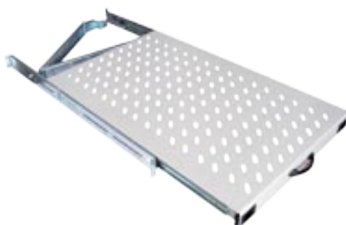
M55 HR720 Полка выдвижная для шкафов ServerMax с фиксацией на защелках и раздвижным кабель-органайзером, нагрузка до 100 кг
