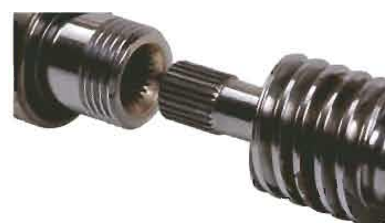
Шлицевое соединение с валом муфты сцепления
