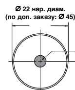
Коаксиальный GWR-зонд, вид снизу
