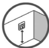
Устанавливается на стене на высоте, соответствующей местным строительным нормам. Обычно 80-150 см от пола.
