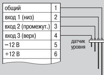
Схема подключения кондуктометрических датчиков уровня
