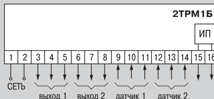
▲ Общая схема подключения 2ТРМ1Б в корпусе Н, Щ1, Щ2N
