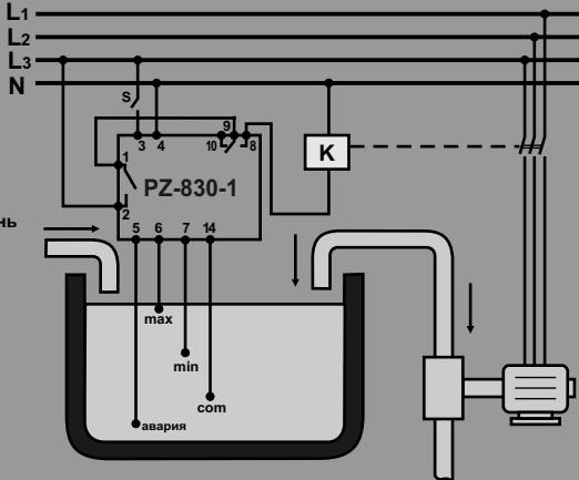
Схема подключения для работы в режиме дренажа. Аварийный уровень ниже минимального (защита насоса от "сухого хода").
