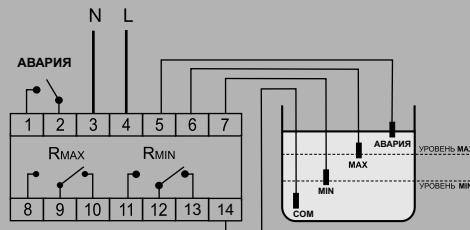
Схема подключения для работы в режиме наполнения.
