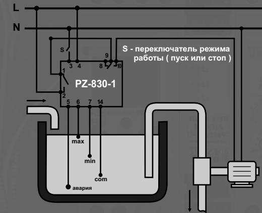
Схема подключения для работы в режиме дренажа с однофазным электродвигателем при его мощности до 800Вт.
