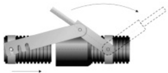
Рис. 11. Устройство для монтажа раструбных соединений с натягом
