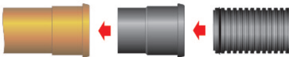
Рис. 16. Соединение труб КОРСИС (гладкий конец) с трубами из ПВХ/ПП
