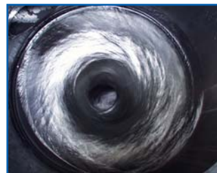
Рис. 41: Преобразование кинетической энергии благодаря турбулентности
