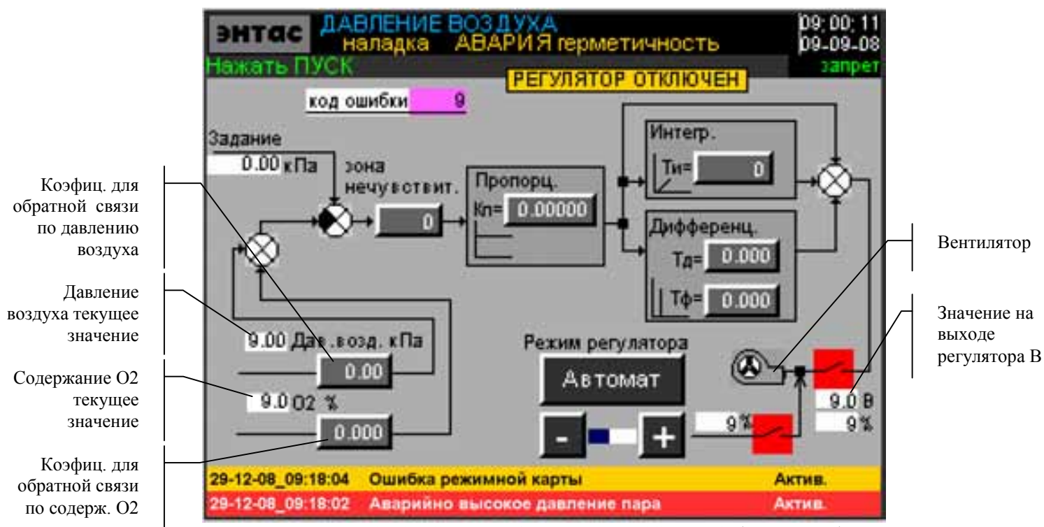
Рисунок 9.33 – Экран ДАВЛЕНИЕ ВОЗДУХА (регулятор).
