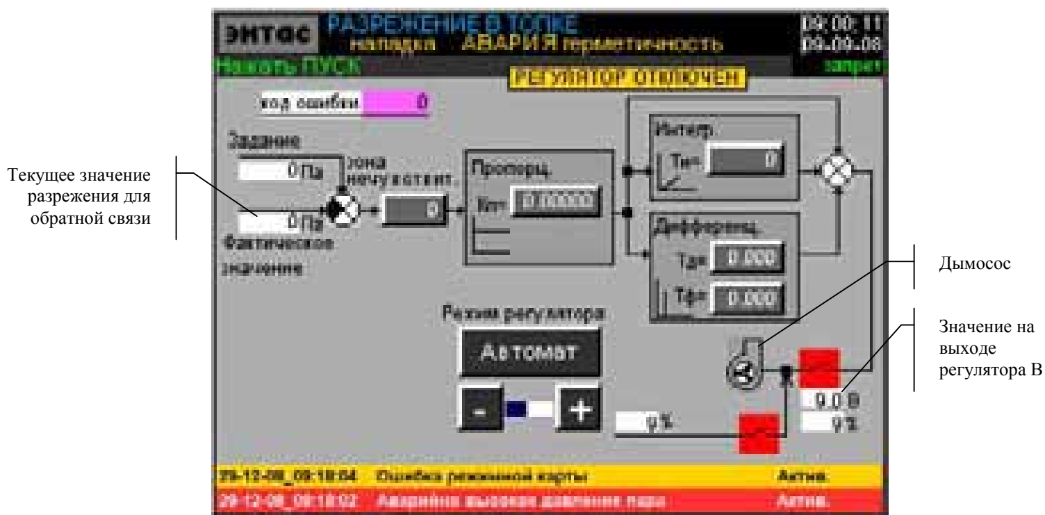
Рисунок 9.34 – Экран РАЗРЕЖЕНИЕ В ТОПКЕ (регулятор).
