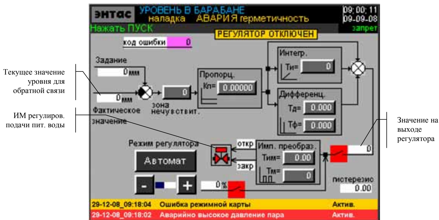
Рисунок 9.35 – Экран УРОВЕНЬ В БАРАБАНЕ (регулятор).
