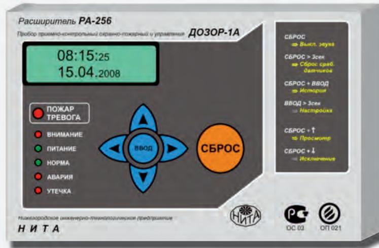
Предназначен для построения эффективной пожарной и охранной сигнализации, а также полнофункционального управления дымоудалением, вентиляцией, оповещением о пожаре, технологическим оборудованием и пожаротушением всех типов (газовым, порошковым, аэрозольным, водяным и пенным) на малых объектах различного назначения, как в автономном режиме, так и совместно с пультами централизованного наблюдения и приемно-контрольными приборами.
