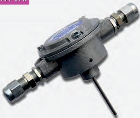
Предназначен для обнаружения возгорания, сопровождающегося повышением температуры внутри контролируемого пространства, и передачи на приемно-контрольный прибор **текущей величины температуры среды**, а также признака пожара при превышении температурой окружающей среды установленных порогов температуры и/или скорости повышения температуры.
