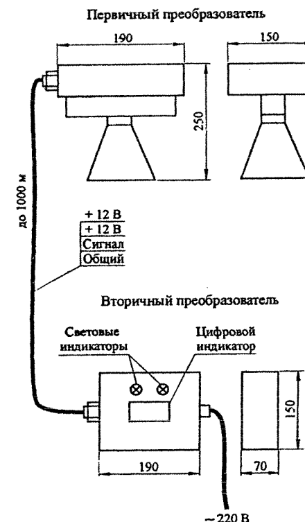
Рис. 233. Схема уровнемера радиоволнового «БАРС-301»
